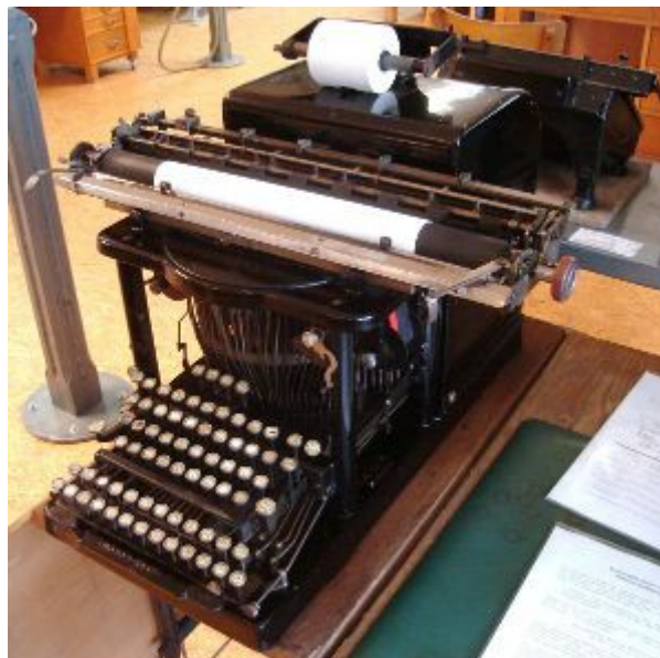
Abb. 12: Burroughs-Moon-Hopkins-Fakturiermaschine, gebaut ab 1902
