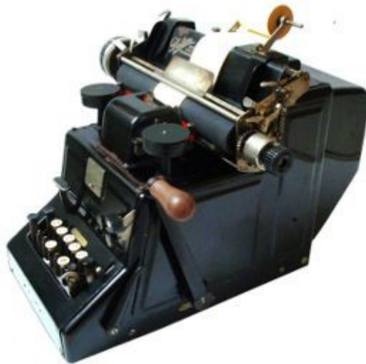
Abb. 10: Dalton-Addiermaschine mit Zehnertastatur;
