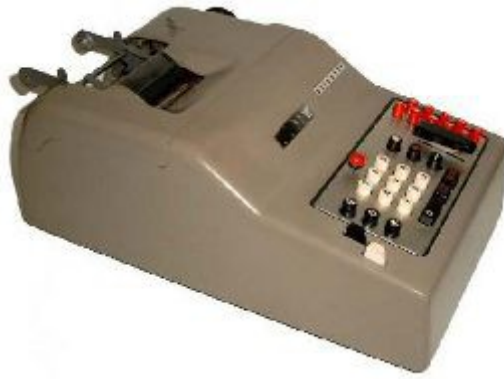
Abb. 13: Olivetti Divisumma 14, druckende Vierspezies Maschine, gebaut ab 1948
